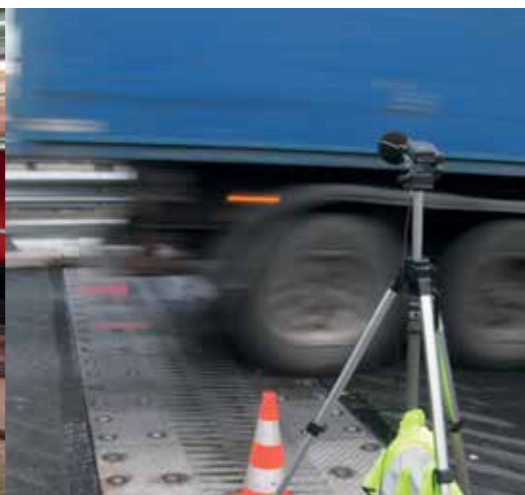
Schalltechn. Beurteilung Fahrbahnübergänge
