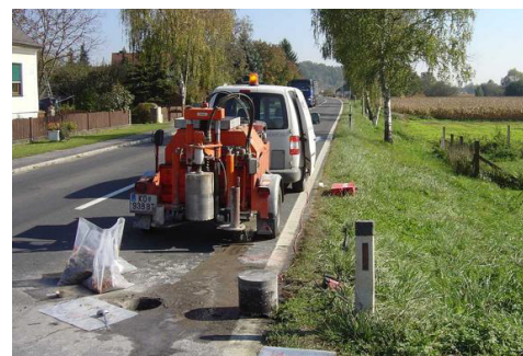
Abbildung 42: Bohrkernentnahme [Foto: Nievelt Labor GmbH]
