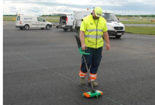
Abbildung 43: Messung der Schichtdicke [Foto: Nievelt Labor GmbH]
