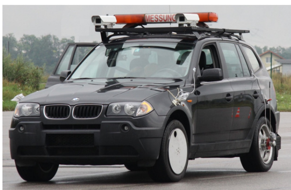
Abbildung 8: Beispiel eines schnellfahrenden Messsystems auf PKW-Basis [Foto: AIT]
