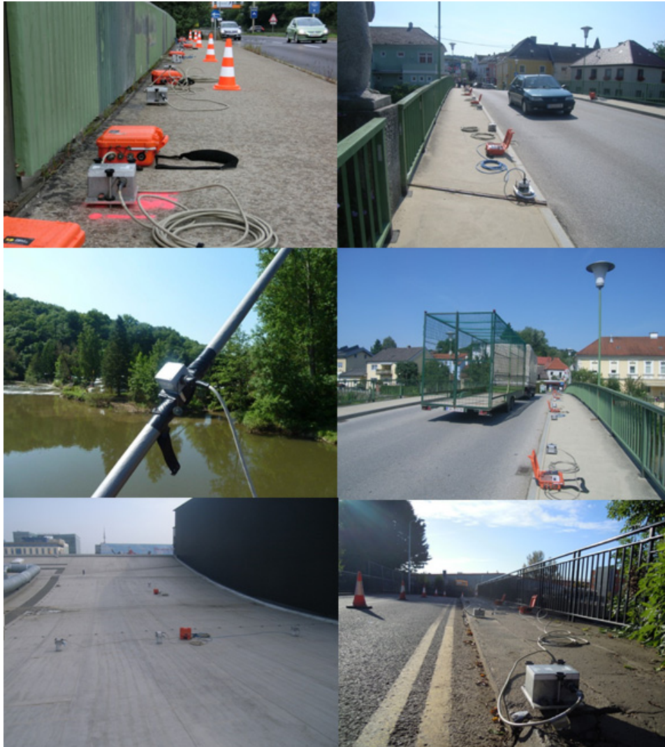
Abbildung 36: BRIMOS® Messraster im Rahmen verschiedener Monitoring-Aufgaben [Fotos: VCE]
