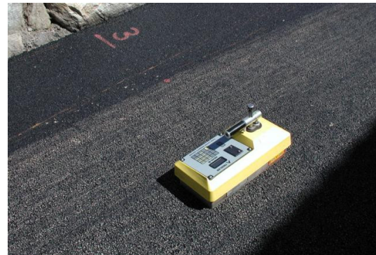
Abbildung 44: Messung der Verdichtung [Foto: Nievelt Labor GmbH]
